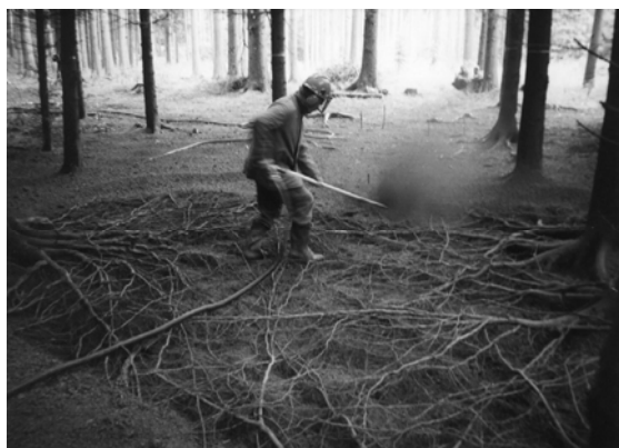
Obr.2: Odkryv kořenového systému smrku na ŠLP Křtiny pomocí supersonického proudu vzduchu (použitý systém Air-Spade Technology, spojený s kompresorem Ingersoll-Rand) – Naděždina a Čermák (2003).
