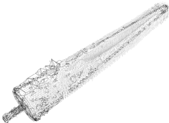
Obr. 4: Vektory působícího větru na plášti stromu, snímek z numerické analýzy (KOŇAS ET AL., 2004)
